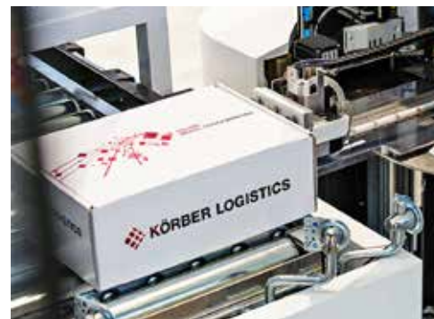
Schonender Griff: Toru erfasst Kartons mit einer Saugereinheit.
