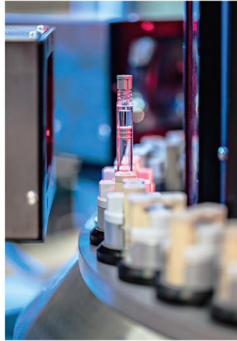
Die Bubble-X-Station (links im Bild) durchleuchtet einen Testcontainer. Im Betrieb geschieht das in Sekundenbruchteilen.
